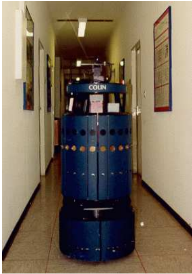
Abbildung 6.15: Der Real World Interface B21 Roboter [244, 243], mit dem die Experimente zur visuellen Steuerung durchgeführt wurden. Rechts ist die verwendete Schwenk-Neige-Einheit zusammen mit den verwendeten Koordinatensystemen für die Kamera \{C\} und die Basis des Roboters \{R\} dargestellt.
