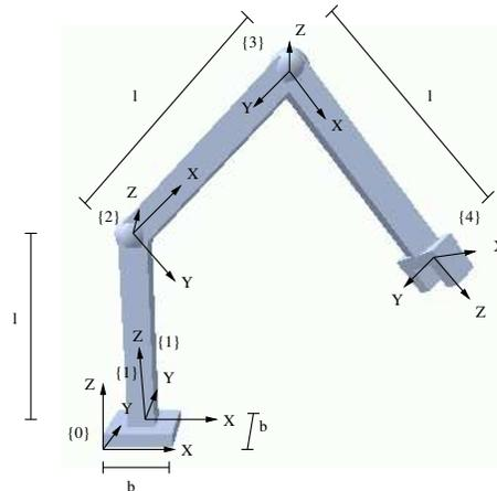
An dem dargestellten Roboterarm sind vier Koordinatensysteme angebracht. Die Z-Achse der Koordinatensysteme 1-4 ist dabei jeweils die Achse, die mit Hilfe eines Motors gedreht werden kann. Geben Sie die Transformationsmatrizen  ${}^0T_1$ ,  ${}^1T_2$ ,  ${}^2T_3$  und  ${}^3T_4$  mit Hilfe der parametrisierten Transformationsmatrizen  $D(d_x, d_y, d_z)$ ,  $R_X(\theta)$ ,  $R_Y(\theta)$  und  $R_Z(\theta)$  an.
