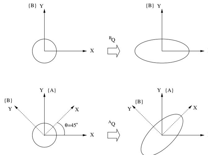
$\{A\}$  und  $\{B\}$  seien zwei Koordinatensysteme. Das Koordinatensystem  $\{B\}$  ist relativ zum Koordinatensystem  $\{A\}$  um  $\theta = 45^\circ$  um die Z-Achse gedreht. Im Koordinatensystem  $\{B\}$  ist die Transformation  ${}^BQ$  (Skalierung um 2 entlang der X-Achse) definiert. Berechnen Sie die Transformation  ${}^AQ$ , die diese Skalierung im Koordinatensystem  $\{A\}$  durchführt.
